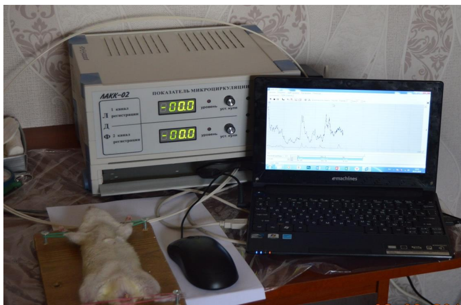
Рисунок 2.10 – Определение параметров микроциркуляции в коже крысы на лазерном доплеровском флоуметре ЛАКК-02
